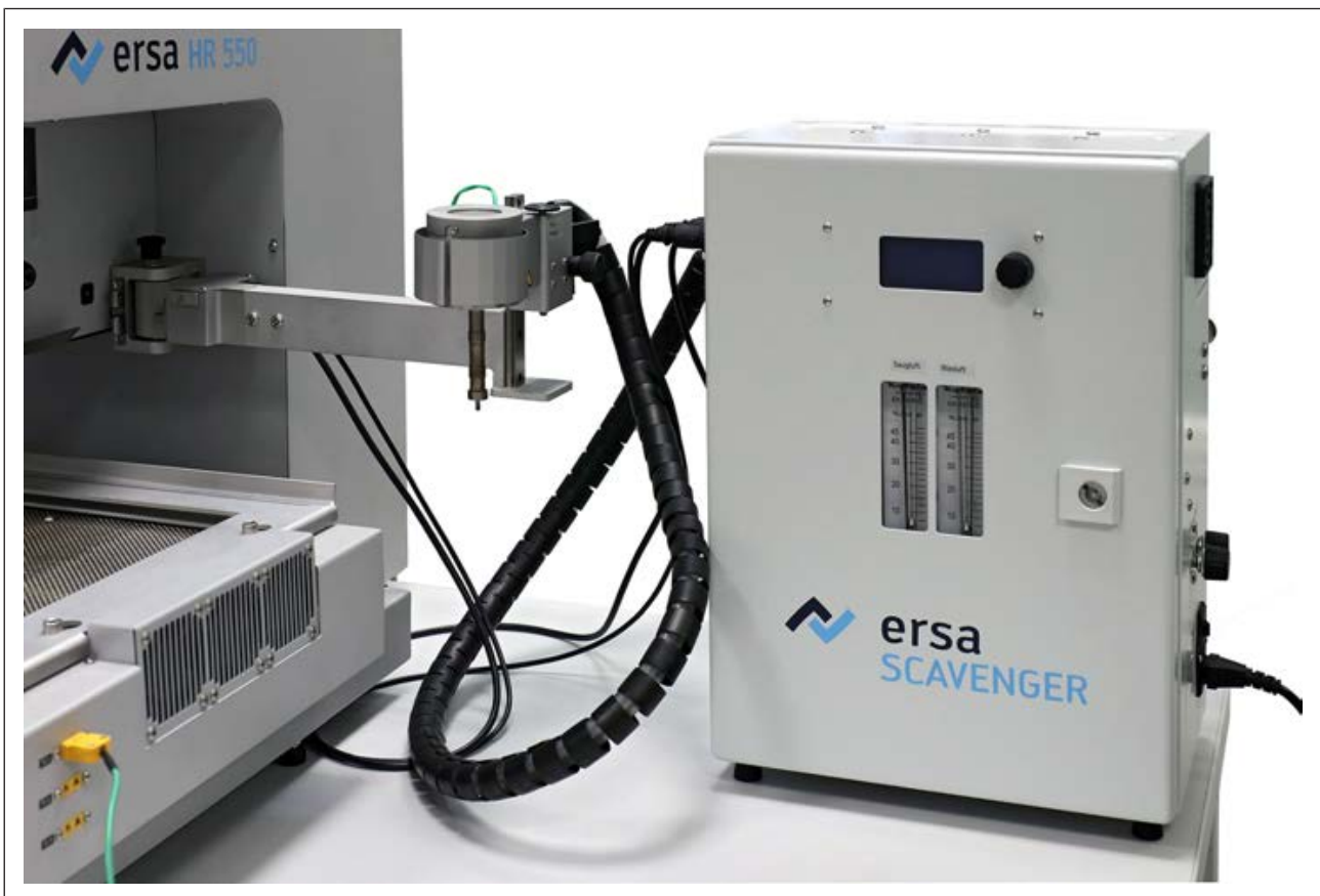
Abb. 37: Optional erhältlich: Restlotabsaugung Scavenger
