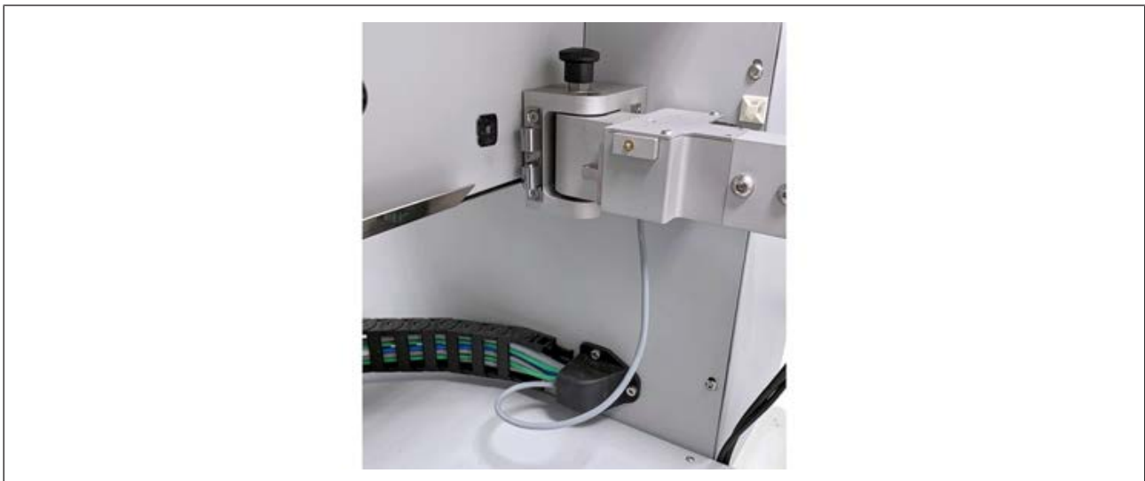
Abb. 15: Kabelverlegung außerhalb des Gehäuses, Bild nach Abschluss der Montage.
