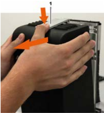
Abb. 47: Heizkopf entriegeln und abziehen.
