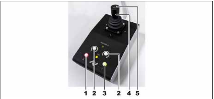
Reworksystem HR 550 XL: ④ Joystick zum Verfahren der Untenheizung. Den Fahrweg freihalten, Kollisionsgefahr!
