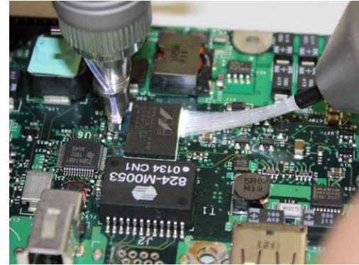
Inspektion eines Micro-BGA
