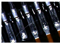
QFP-Lötstellen aufgenommen mit dem MacRoZoom-Objektiv
