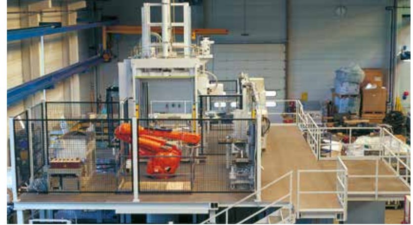
Niederdruckgießzelle zur Produktion von Bedplates
