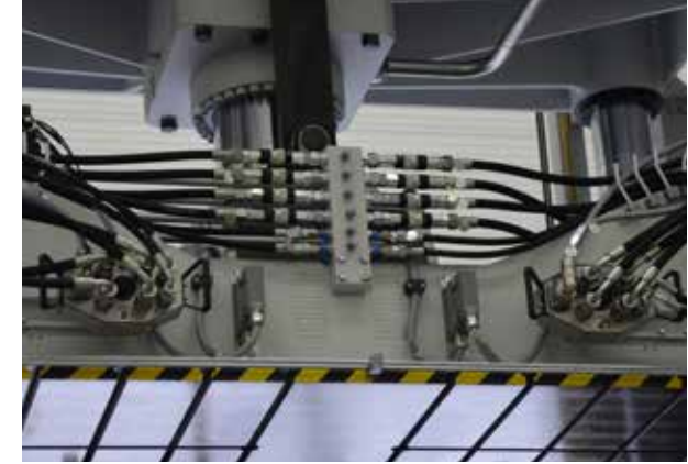
Multikupplung am Stößel in Parkposition
