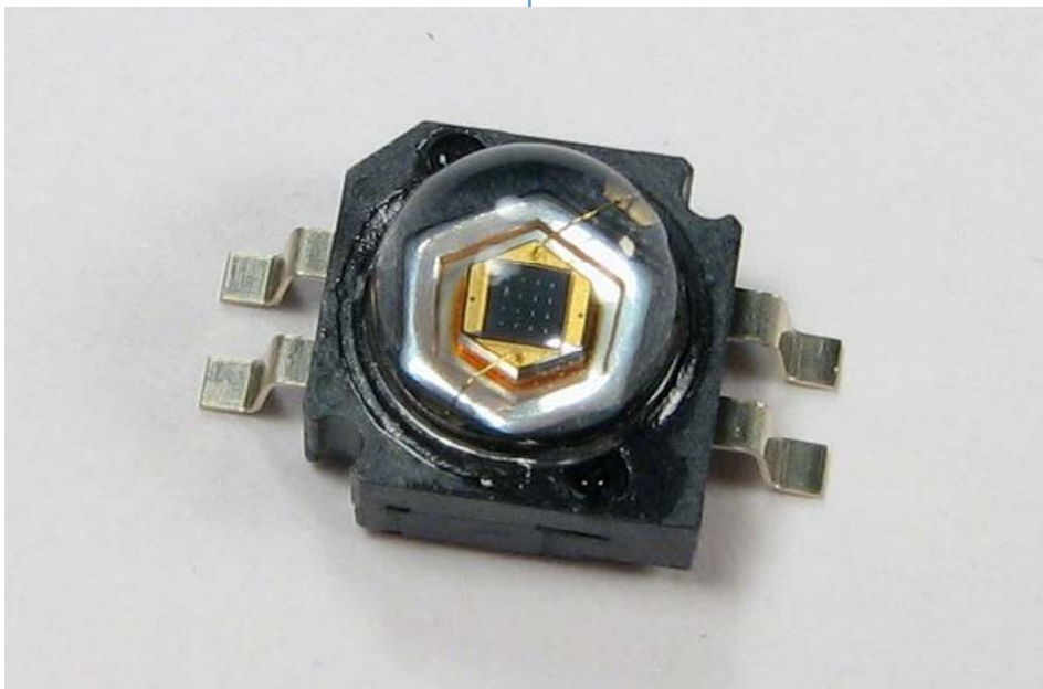
LED with gull-wing connectors Source: https://de.m.wikipedia.org/wiki/Datei:Luxeon_K2_LED.jpg
